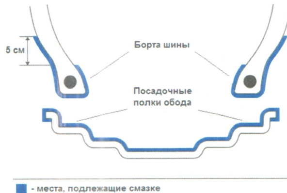
Рисунок 21 – Схема нанесения смазочных материалов на покрышку и обод
